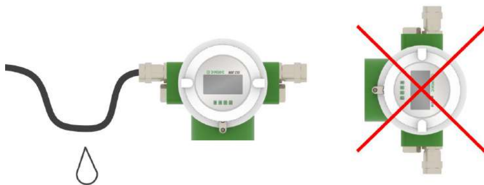
Рисунок 2.8 - Рекомендации по расположению кабелей и кабельных вводов
